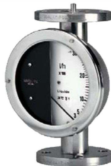
Esta serie de instrumentos ha sido diseñada para medir el caudal de fluidos en lt / h. Los valores medibles de caudal varían desde fracciones de m<sup>3</sup> / h hasta 50 m<sup>3</sup>, con una precisión de medición que puede alcanzar hasta el 1% del valor de la escala completa. La sensibilidad del instrumento también es muy alta: es posible medir un caudal igual a 1/10 del nominal.
